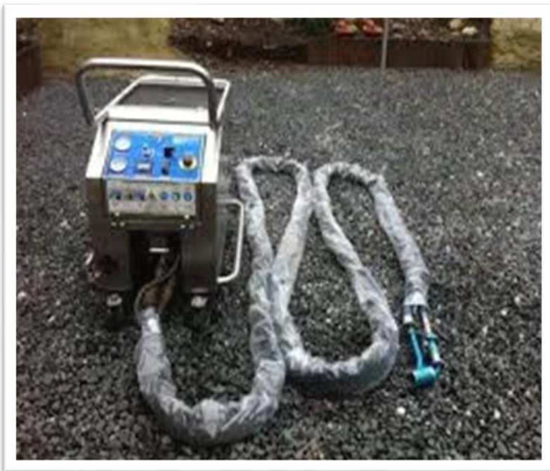
Die Mini Jet von Green Tech war zwar noch ein Zweischlauchsystem, dennoch war damit in Handhabung und Handling bereits ein großer Fortschritt erzielt
